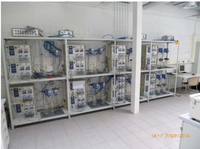
Mit der biogeochemischen Mikrokosmen-Anlage lässt sich die Überflutung von Böden simulieren
