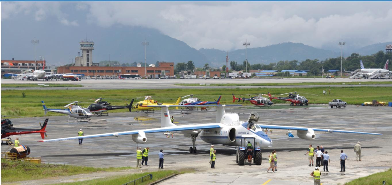
Abb. 1: Das einzige Höhenforschungsflugzeug M55 Geophysica kann über 20 Kilometer hoch fliegen. Hier steht es im Juli 2017 auf dem Rollfeld in Kathmandu, um erstmals Messflüge im Bereich des asiatischen Monsuns bis in die Stratosphäre durchzuführen. Mit an Bord: das Wuppertaler Messgerät HAGAR („High Altitude Gas Analyzer“), mit dem das BUW-Team die Luft auf CO<sub>2</sub>, N<sub>2</sub>O, FCKWs und weitere langlebige Spurengase analysierte.
